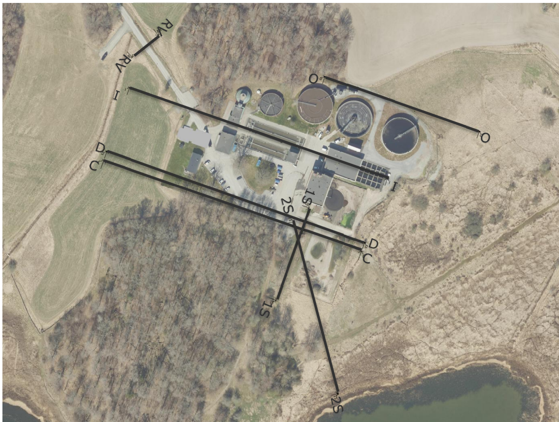
Figur 8. Sektioner där stabilitetsberäkningar utförts.
